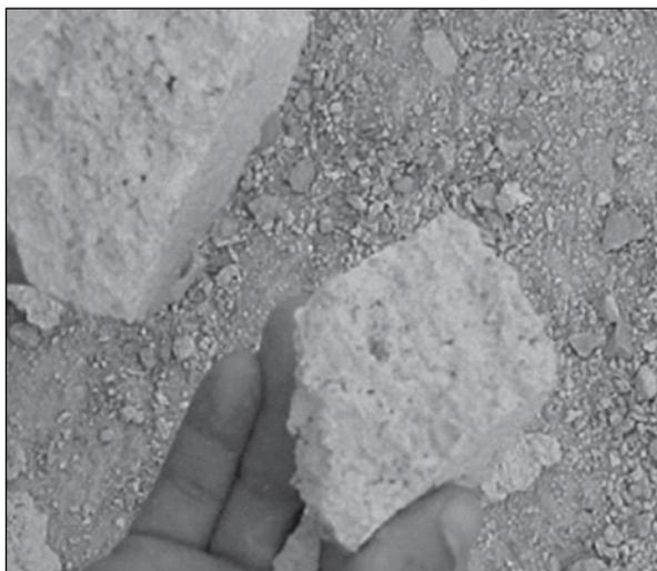
**Figura 2** ■ | Fragmento de bloque de concreto contaminado con materia orgánica, la pieza corresponde a un fabricante de San Cristóbal de Las Casas, Chiapas, en esta región se suna a las patologías el fenómeno de reacción química alcalo silice.
