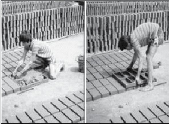
Figura 6 (a y b) ■ Planta artesanal de fabricación de piezas de arcilla en las orillas de las áreas urbanas de Oaxaca (Alcocer *et al*, 1999)
