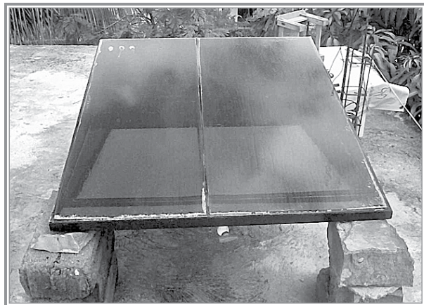
Figura 2 ■ | Imagen del prototipo de destilador solar realizado.
