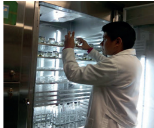
Figura 3. Cámara germinadora para consentir a las semillas controlando los parámetros ambientales, en las que germinaran.
